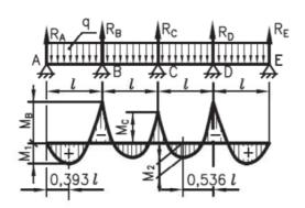
$$\begin{split} R_A &= 0,393 \cdot q \cdot l \quad R_B = 1,143 \cdot q \cdot l \\ R_C &= 0,929 \cdot q \cdot l; \quad R_D = 1,143 \cdot q \cdot l \\ R_E &= 0,393 \cdot q \cdot l \\ M_1 &= \frac{1}{13} \cdot q \cdot l^2; \quad M_B = -\frac{1}{8,55} \cdot p \cdot l^2 \\ M_C &= -\frac{1}{14,1} \cdot q \cdot l^2; \quad M_2 = \frac{1}{27,75} \cdot q \cdot l^2 \end{split}$$
