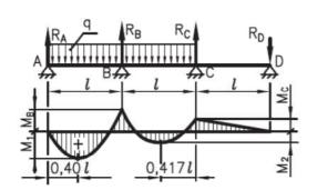
$$\begin{split} R_A &= 0,383 \cdot q \cdot l; \quad R_B = 1,2 \cdot q \cdot l \\ R_C &= 0,450 \cdot q \cdot l; \quad R_D = 0,033 \cdot q \cdot l \\ M_1 &= \frac{1}{12,7} \cdot q \cdot l^2; \quad M_B = -\frac{1}{8,55} \cdot p \cdot l^2 \\ M_C &= -\frac{1}{30,3} \cdot q \cdot l^2; \quad M_2 = \frac{1}{18,3} \cdot q \cdot l^2 \end{split}$$
